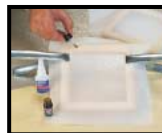
Loctite® 7239 Праймер общего назначения, применяемый для всех типов промышленных пластмасс для увеличения адгезии клеев моментального отверждения.
